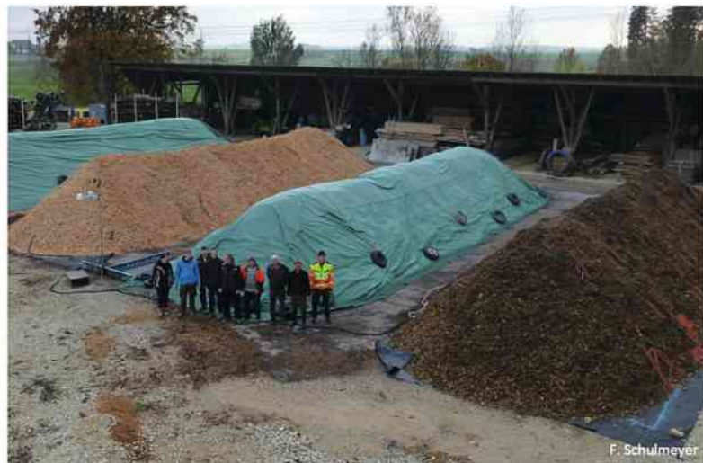
Bild 7: Lager- versuche von Holz in Poltern (links oben) sowie als Hackschnitzel offen und abgedeckt. Foto rechts mit Versuchsanordnung links unten. (Hofmann et al. 2016 in [1])
